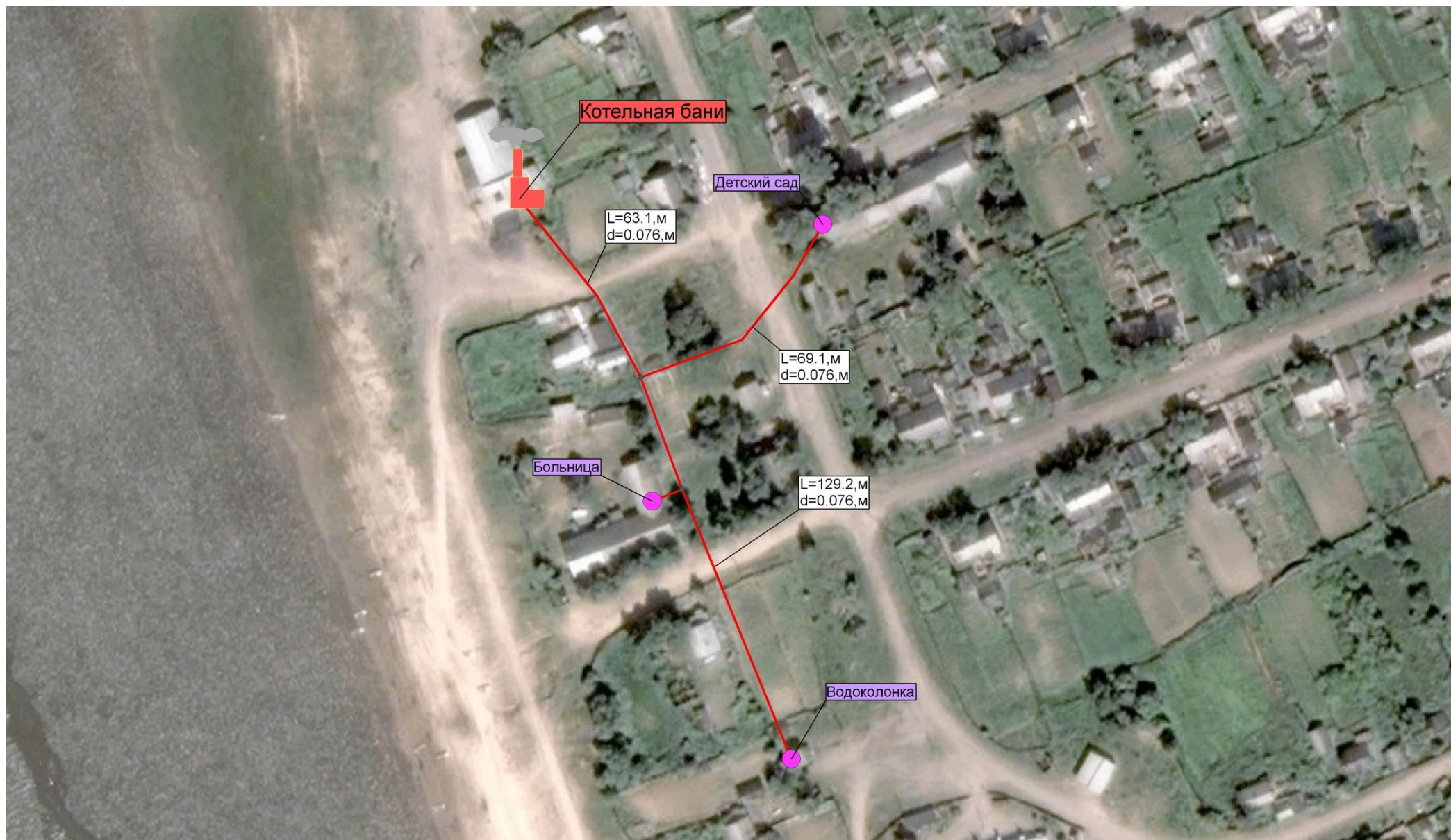
Рис. 1.4 – Схема теплоснабжения муниципального образования «Мариинское сельское поселение» от котельной бани п. Мариинский Рейд
